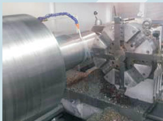
На этих станках обрабатывают валки и кольца с максимальным диаметром до 2000 мм и общей длиной до 6000 мм. В токарном цеху осуществляют обработку по всем технологическим стандартам, что предполагает контроль качества на всех этапах производства через определенные промежутки времени.
